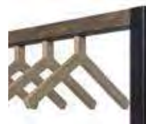
K1844HGH ハンガー / w260, d12, h169 ブナ芯合板 塗装：ナチュラル色、ウォールナット色 ウレタン艶消し *垂直荷重 10Kg
